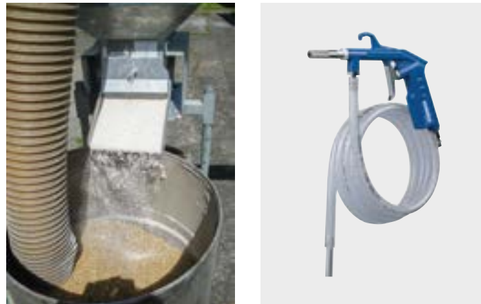
Applikator für die Einmischung von Silico-Sec in Getreide, rechts eine Druckluftpistole für die Leerraumbehandlung. Beide Geräte können auf Anfrage bei Andermatt Biocontrol Suisse bezogen werden.
